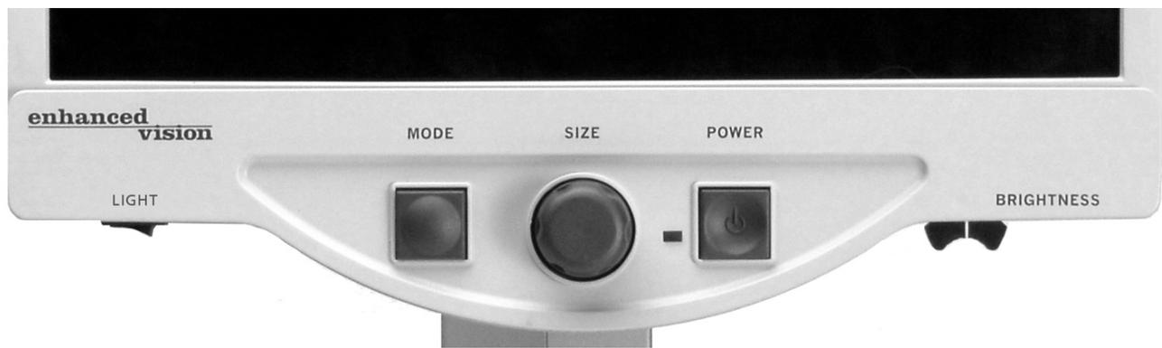
Sie können eine Ansichtsoption wählen, indem Sie die „MODE“-Taste auf dem Bedienungsfeld drücken. Bei jedem Drücken wechseln Sie durch alle 7 Ansichtsoptionen. Die verfügbaren Optionen sind:
